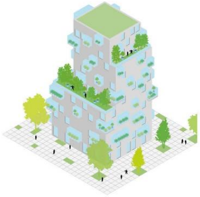
Getrapte toren Veemarktweg volume: stapelen materiaal: beton gevel: indeling met diepte: pixels buitenruimte: daktuinen en wintertuin
