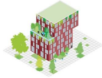
Getrapt bouwblok Parallelweg volume: uitkragen materiaal: baksteen gevel: combinatie binnen grid buitenruimte: daktuinen
