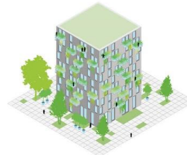
Mini-toren N. Mandelalaan volume: verticaal materiaal: beton gevel: eenvoudige grid-indeling buitenruimte: groene balkons
