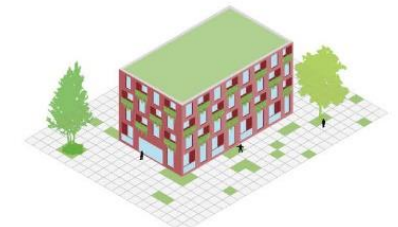
Bouwblok Parallelweg volume: horizontaal materiaal: baksteen gevel: indeling met diepte: loggia buitenruimte: groene loggia's
