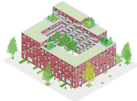
Gesloten bouwblokken N. Mandelalaan volume: getrapt materiaal: baksteen gevel: indeling met diepte: loggia buitenruimte: groene loggia's
