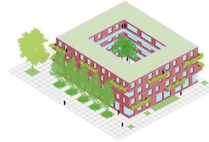
Gesloten bouwblok Parallelweg volume: horizontaal materiaal: baksteen gevel: diversiteit binnen grid buitenruimte: balkons met planters
